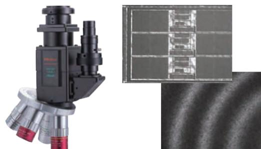
通过与本公司制M Plan Apo NIR系列等支持红外区的物镜组合，可在红外线下实现可见光下做不到的非破坏性检查。
