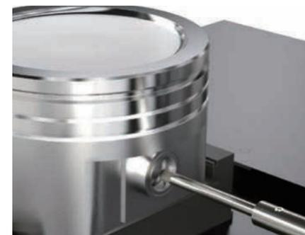
检测测针从测量面的意外下落，在中断测量的同时控制下落速度，有助于避免测针破损。
