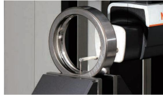
为了防止烧粘和磨损，轴承套圈（外圈/内圈）的形状和表面粗糙度要求能够充分发挥润滑油的效果。H-3000 检出器具有宽测量范围和高分辨力，只需 1 次测量即可高效、高精度地评定轮廓和表面粗糙度。
