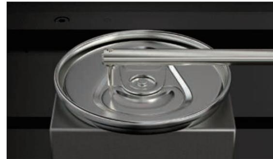
易拉罐罐盖的槽如果太浅则打不开，如果太深则会因运输时的振动或冲击而使盖子打开，导致罐内的东西漏出。在要求高精度的易拉罐槽形状测量中，可高效地对产品槽尺寸进行管理。
