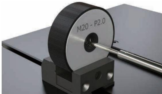
利用 C-4500 检出器的上/下方向连续测量功能，可同时测量螺纹塞规及环规的有效直径、螺牙角度和螺距。使用标准软件的工件程序创建功能，可以高效地测量要求微米级高精度的有效直径。
