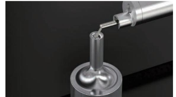
药片模具取决于药剂粉末的剥离性和可以降低成本的耐久性。FORMTRACER Avant 系列通过缩短助走距离可以实现产品边到边的精确测量，正确、精密地评定模具的表面粗糙度。
