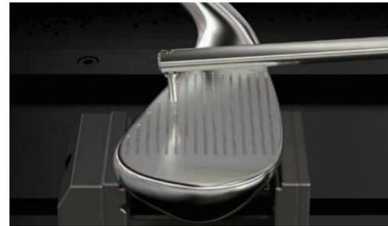
根据高尔夫俱乐部规定，对球杆的槽宽及槽间隔、边缘形状都有严格规定。在高精度测量的同时，还可以通过创建标准功能工件程序（自动测量程序）及分析操作的自动化，进行高效地测量评定。
