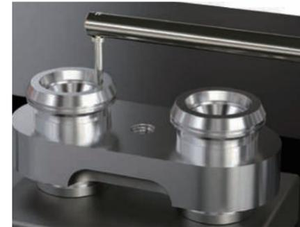
可登录检出器保持位置，能从登录的保持位置进行测量，且无需担心掉落。借助此功能，无需用限位挡块就可连续测量缺口工件。
