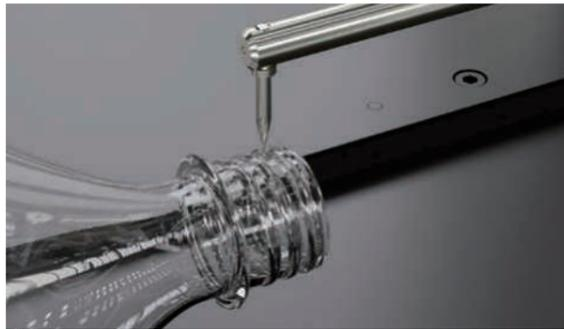
我们熟悉的塑料瓶的螺纹，如果比较松，瓶内的东西就会漏出，而如果比较紧，则瓶盖无法拧入，因此需要进行高精度测量。如使用圆锥测针，这类塑料瓶的“螺纹截面形状”也可以高效地进行角度或螺距测量，而无需切断产品。
