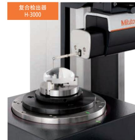
搭载新开发的圆弧栅尺，是一款宽范围高分辨力的检出器。无需更换检出器，一次追踪即可同时评定轮廓形状和表面粗糙度。有助于缩短测量时间。
