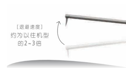
测针抬起(退避)的速度比以往机型高，另一方面，考虑到安全测量，使测针缓慢下降来接触工件。自动检测与工件的接触，可迅速开始测量。通过缩短总测量时间，提高了测量效率。
