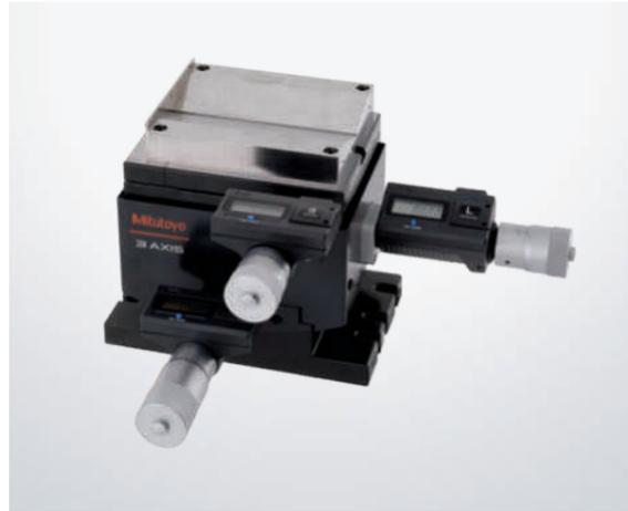
为圆柱形工件的表面粗糙度和轮廓形状测量而备。为了实现高精度测量，工件的母线轴和测量轴平行的同时，也需要调整水平。使用3轴调整工作台，无需经验，只要遵循操作导航指示即可轻松调水平。
