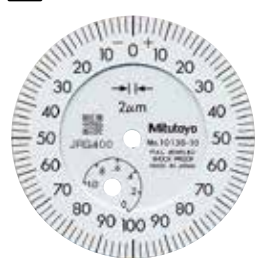
分度值：0.002mm, 测量范围：1mm 1013S-10 防震型 宝石轴承型
