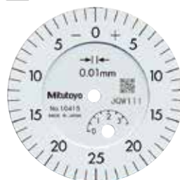
分度值：0.01mm, 测量范围：3.5mm 1041S 双刻度面型
