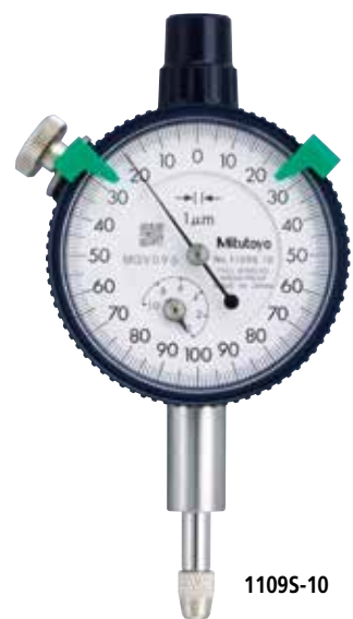
分度值：0.001mm, 测量范围：1mm 1109S-10 防震型 宝石轴承型
