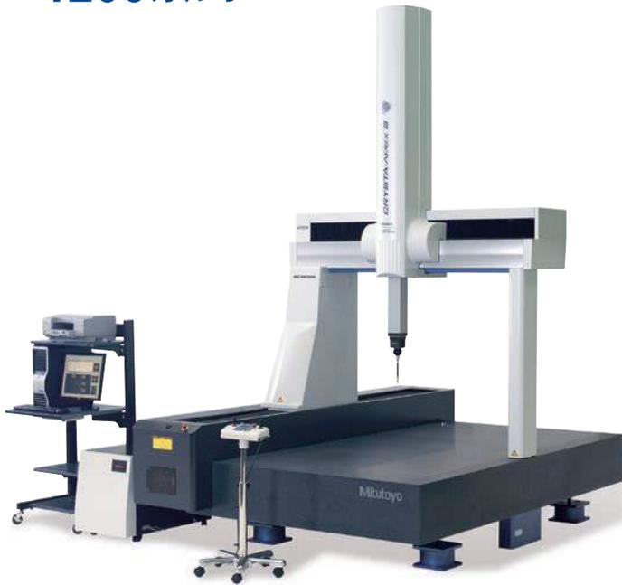
注意：该机器包含一个本体启动系统(重新定位检测系统)，当出现意外震动或机器被迁移时机器将无法操作。初装之后若迁移机器，请提前就近联系三丰公司。
